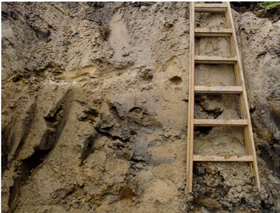
Abbildung 6 Blick auf die südliche Grubenwand mit Feinsanden über Geschiebelehm
